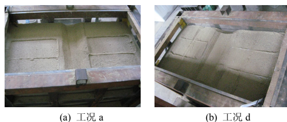
图7 卸载后地基表面变形
