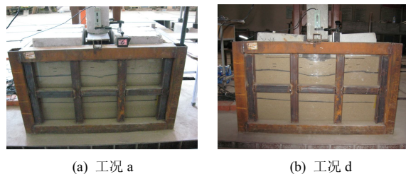
图8 地基破坏时的变形
